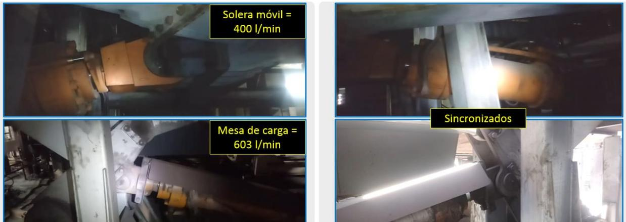
**Imagen 17. Comparativo de Sincronización de Sistemas Hidráulicos**
